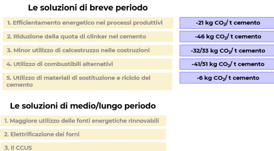
Figura 9 – Soluzioni possibili per la riduzione delle emissioni di CO 2 nella produzione di cemento 47 . Le riduzioni stimate sono relative a scopo 1, 2 e 3 e non sono quantificate per le tecnologie non ancora mature
